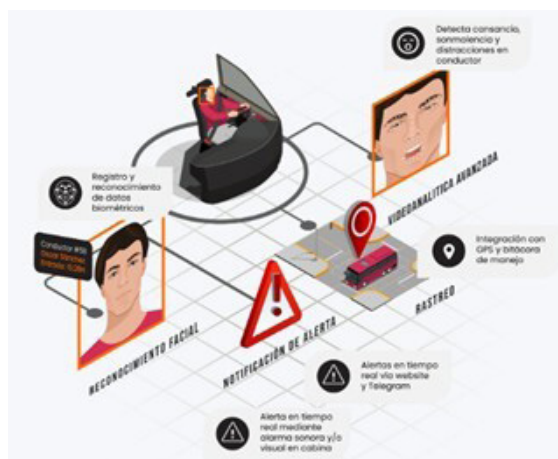
Figura 11: Video analítica enfocada a seguridad vial utilizando el reconocimiento facial de conductores para detectar distracciones e indicadores de cansancio al conducir, enviando alertas al instante, previniendo accidentes. Fuente: Introid, 2024
