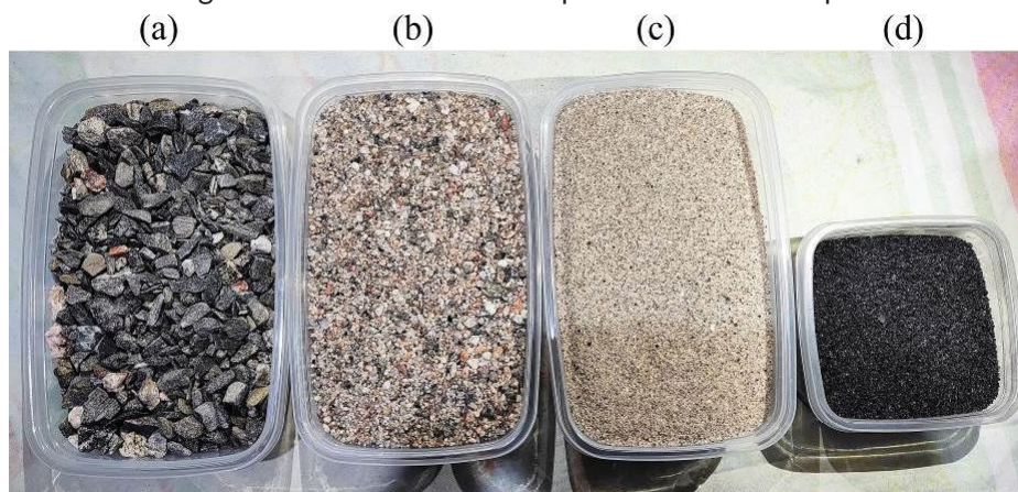
Figura 4. Materiales utilizados para un filtro multicapas
