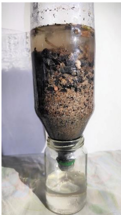
Figura 5. Ejemplo de filtro multicapas casero
