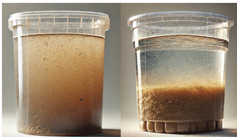
Figura 2. Agua no potable turbia (izquierda) y decantada (derecha)
