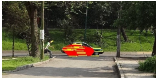
Figura 5. Ejemplo de una cubierta convexa a partir de vectores de flujo óptico
