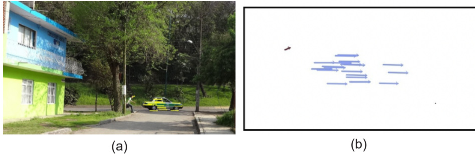
Figura 4. Vectores resultantes de un movimiento a través de un proceso de flujo óptico
